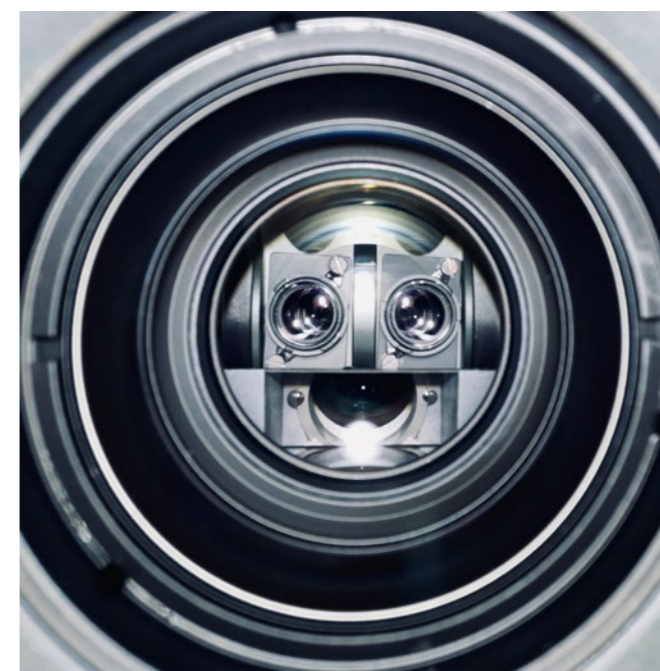
圖九: 患者視野看到的顯微鏡同軸光源與雙鏡頭
