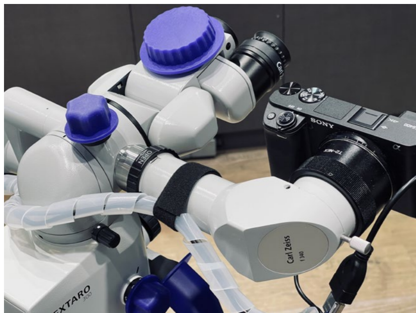
圖十四: Zeiss Extaro 300 外接 Sony a6400 數位相機
