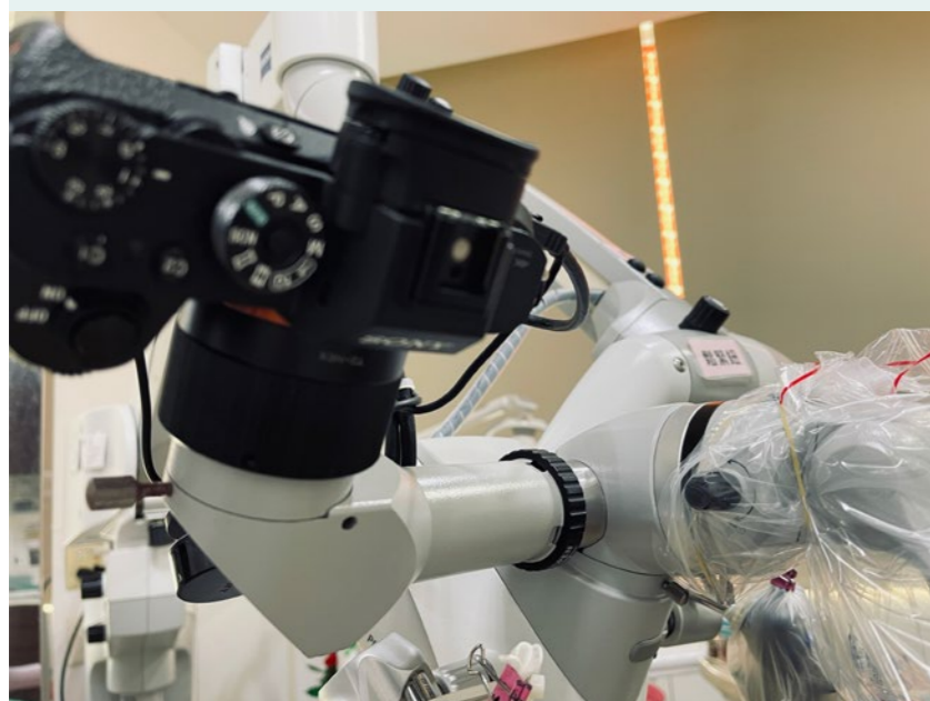
圖十五: Zeiss ProErgo 外接 Sony A7R3 數位相機
